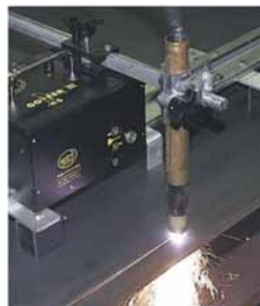
A foto acima mostra o corte Plasma mecanizado com tartaruga.
