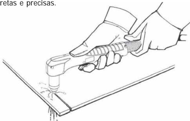
5) No caso do corte iniciar no meio da chapa ou para fazer furos, a técnica indicada é iniciar o corte com o bico inclinado.
